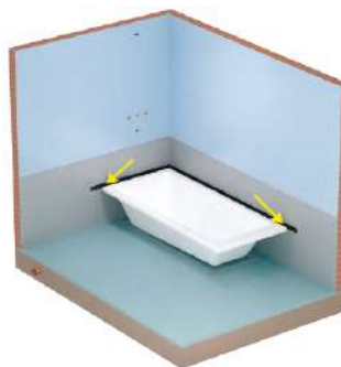
Figura 7- Retirar film protector del borde de la bañera a embutir. Embutir la bañera entre 1 cm. y 1,5 cm.
